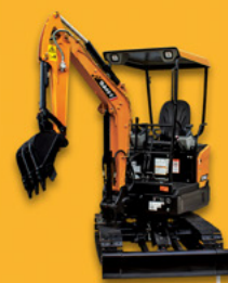
SY16C ESTEIRA DE LARGURA AJUSTÁVEL PESO OPERACIONAL: 1820 Kg
