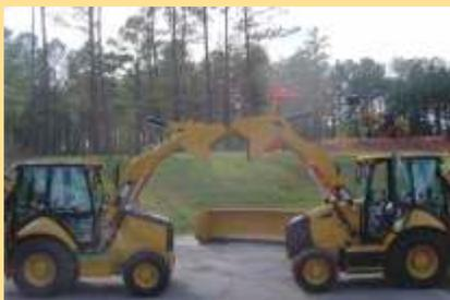
Comparativo com série E: o braço da retroescavadeira da série F2 (equipamento à direita), em seu novo desenho, tem barras paralelas e ganhou em aumento da força de levantamento e desagregação, maior alcance dentro da carroceria de caminhões e mais espaço para descarga
