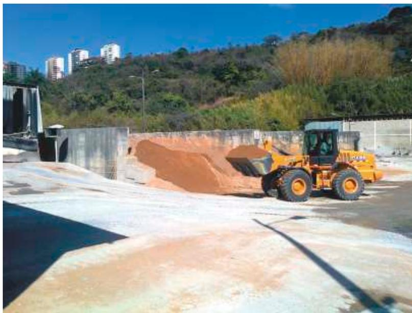
**A 621D** tem caçamba de 2,1 metros cúbicos com lâmina reta aparafusada, pneus 20,5 x 25 L3 e eixos dianteiro e traseiro com sistema antipatinagem
