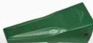
A ECOPLAN FABRICA DIVERSOS TIPOS DE PONTAS, SUPORTES, CANTOS E PROTETORES DE CAÇAMBA PARA ESCAVADEIRAS HIDRÁULICAS. O AÇO ECOPLAN ME12 LIGADO AO CRÔMO, NÍQUEL, MOLIBDÊNIO E MANGANÊS TEM ALTA RESISTÊNCIA A IMPACTO E GRANDE DURABILIDADE FRENTE A ABRASÃO. NA MINERAÇÃO E CONSTRUÇÃO PESADA AS ESCAVADEIRAS ENFRENTAM ROCHAS E DIVERSOS TIPOS DE SOLOS ABRASIVOS.
